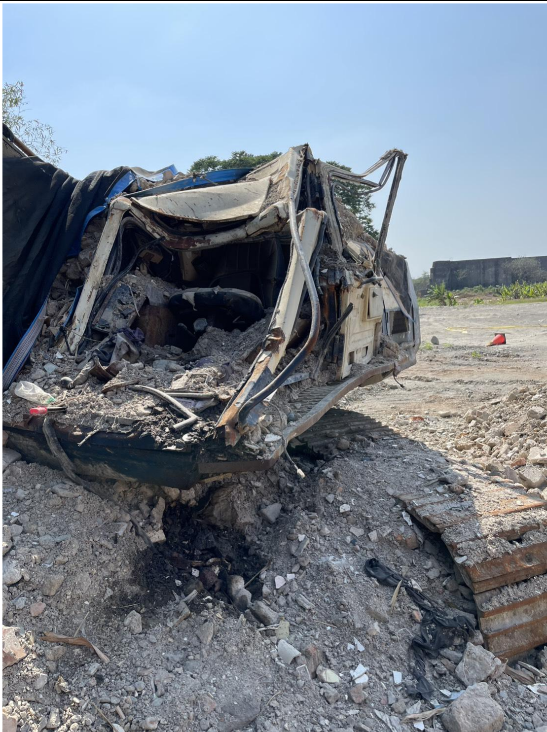
照片 3：砂石車車斗(連同營建廢棄物)翻覆倒塌後壓到挖溝機 駕駛艙
