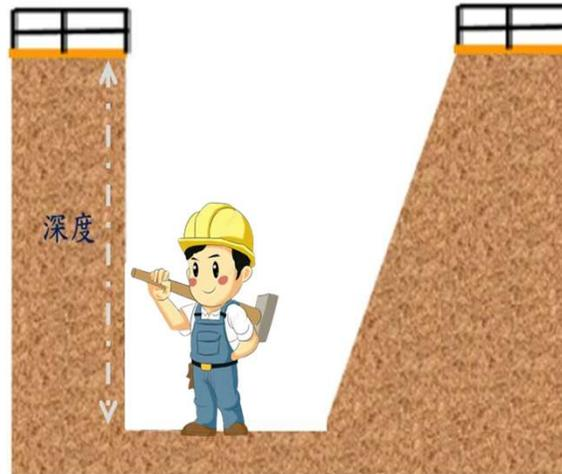
因露天開挖之坡面角度可包含任何角度，不只有垂直90度之坡面，原條文垂直開挖深度易被誤解為只有從事垂直開挖要辦理規定事項，爰將「垂直開挖」修正為「開挖垂直」，不論任何角度坡面之開挖，只要垂直深度達一點五公尺以上即應設擋土支撐。
