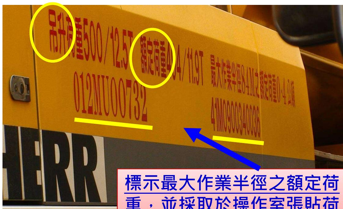
標示最大作業半徑之額定荷重，並採取於操作室張貼荷重表及置備攜帶式荷重表
