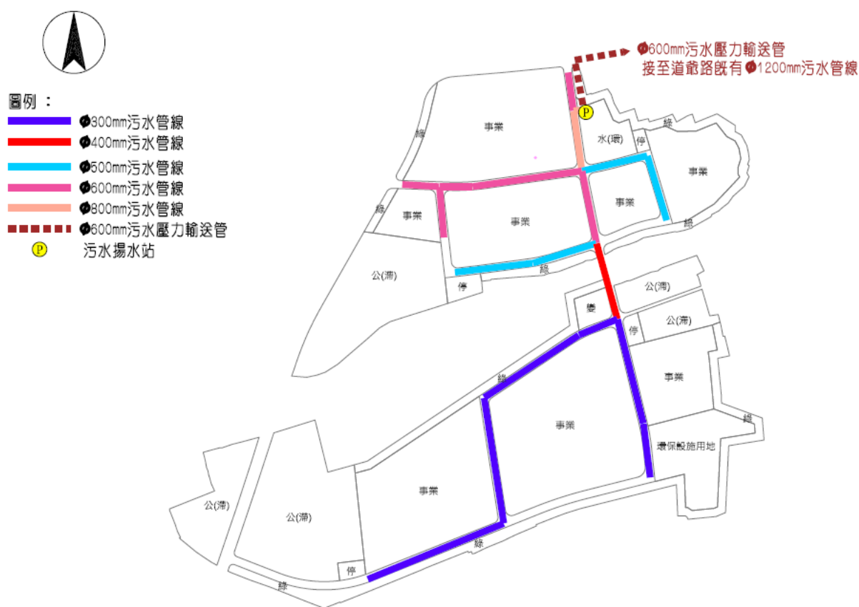
圖 3.2-9 看西農場區廢水管線配置圖
