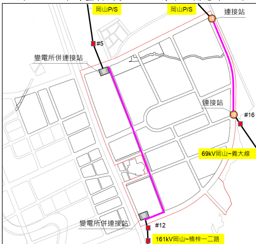
圖 3.2-8 本計畫建議架空輸電線路下地示意圖
