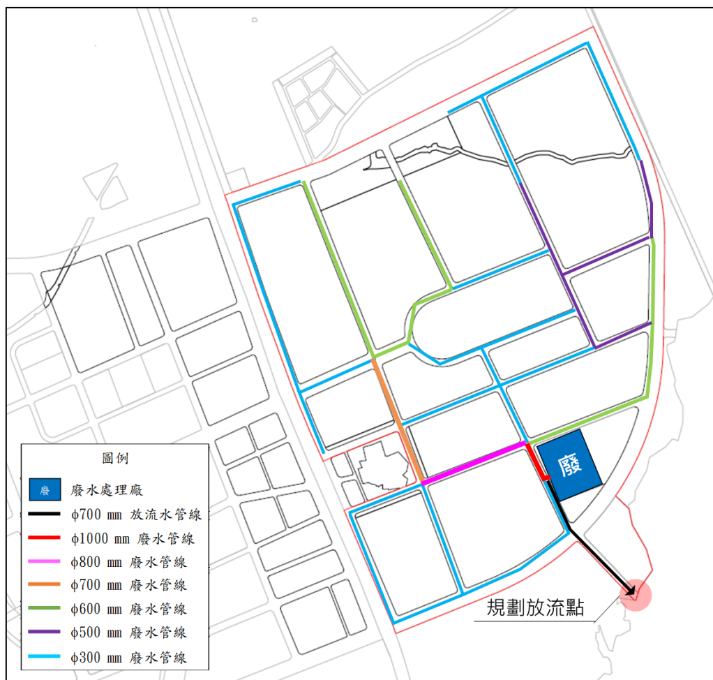
圖 3.2-4 本計畫污水收集管線系統初步規劃配置圖
