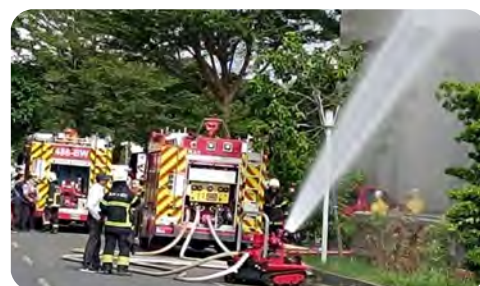
操作遠距遙控砲塔車進行滅火
