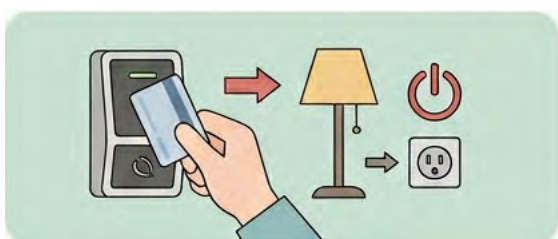
5. 節能插卡裝置，確保全面斷電
