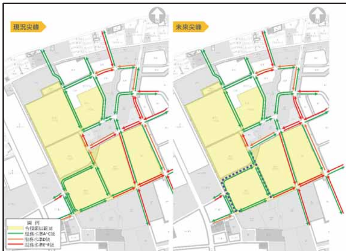
圖 4-7 一、二期園區西北側模擬交通動線調整前後路段服務水準示意圖
