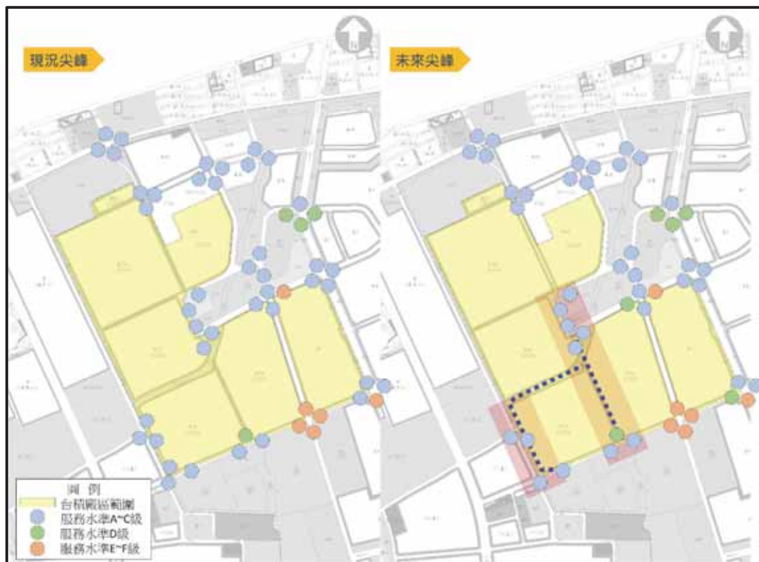
圖 4-8 一、二期園區西北側模擬交通動線調整前後路口服務水準示意圖
