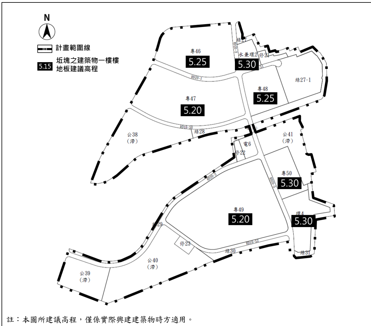
圖7 本計畫區建築物一樓樓地板高程示意圖
