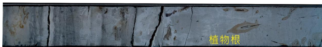
圖版 52 輕微風化泥層，呈灰白色，保存原生植物根。 (孔位編號 J01，深度 19-20m，左側為頂部)
