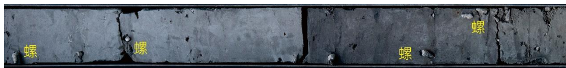
圖版 51 含海螺泥層，受強烈生物擾動。 (孔位編號 J01，深度 14-15m，左側為頂部)
