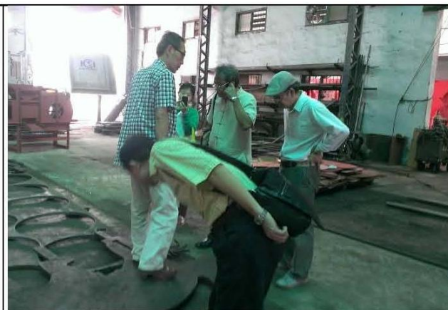
↑ 查驗鋼板厚度及邊緣。
