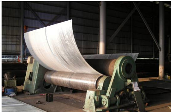
1-1. 碳鋼板曲面處理
