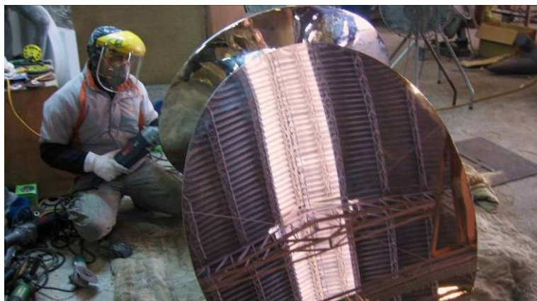
1-2. 不鏽鋼鍛造鏡面拋光
