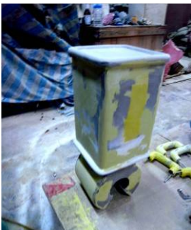
1-7 機器人手部外殼翻模及補土表面處理
