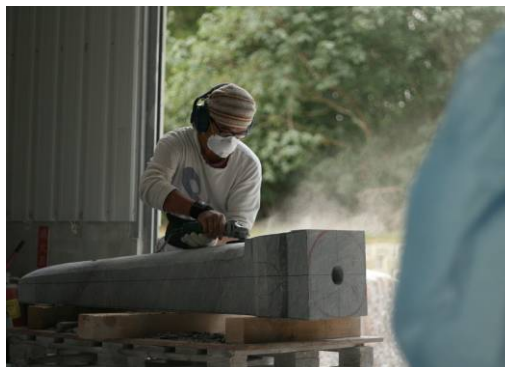
1-4. 主結構白色大理石整體粗胚 至修細研磨過程
